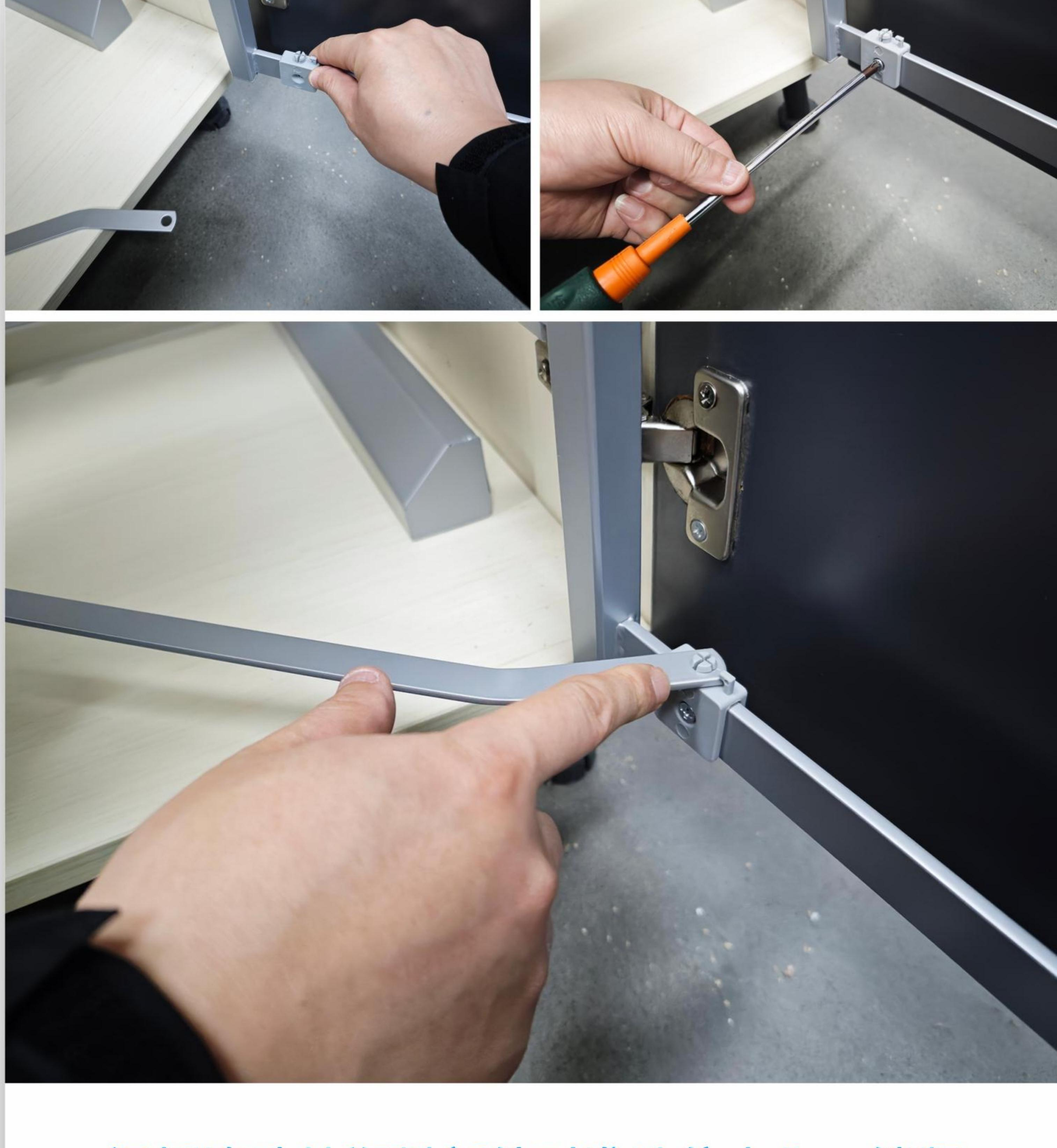
门板连动处塑料部件对准孔位卡入，锁紧 M5\*8螺钉，连动杆孔对准门板转动连接处，向下按压（注意连动杆方向）。
