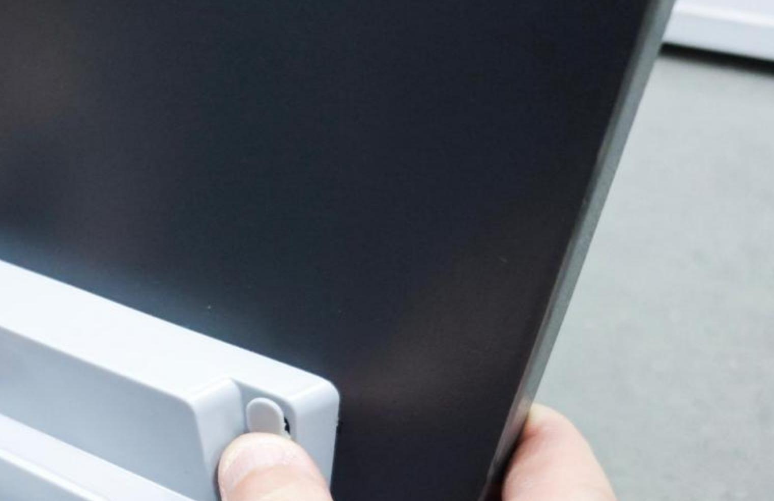
在第一条基准线上，距离柜门边43mm处确定基准点，门板导向支架固定件下部孔位对准基准点，锁紧ST4.0\*16自攻螺钉，依次锁紧支架。
