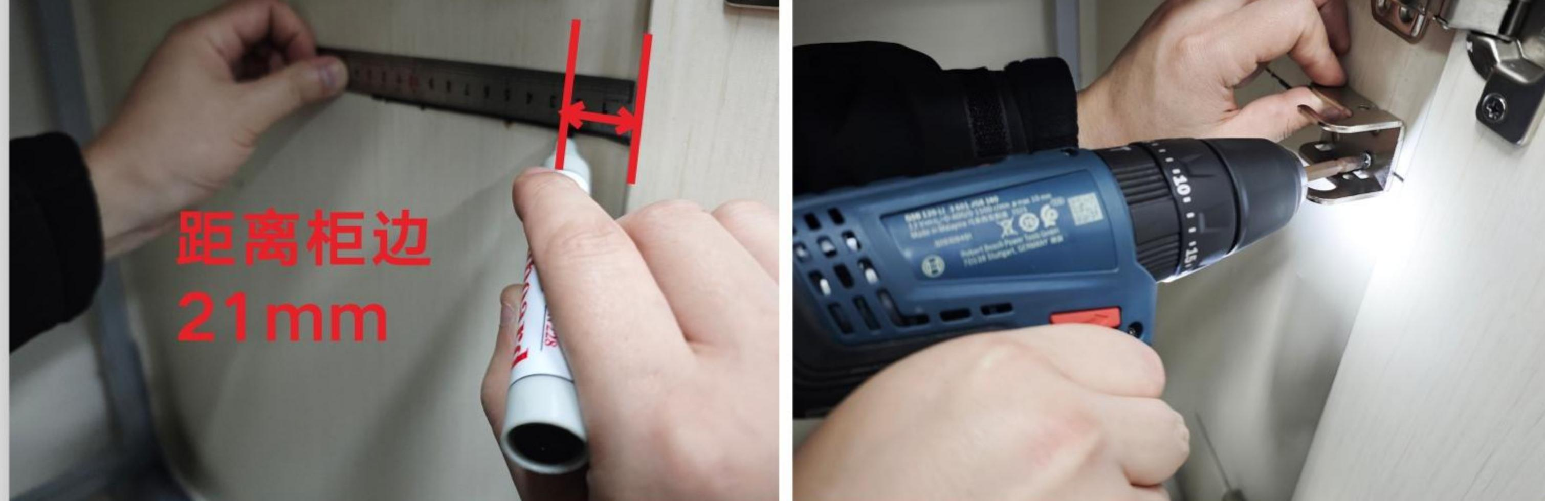
在第二条基准线上，距离柜边21mm处确定基准点，使用ST4.0\*16自攻螺钉对准基准点，固定上部转动底座。
