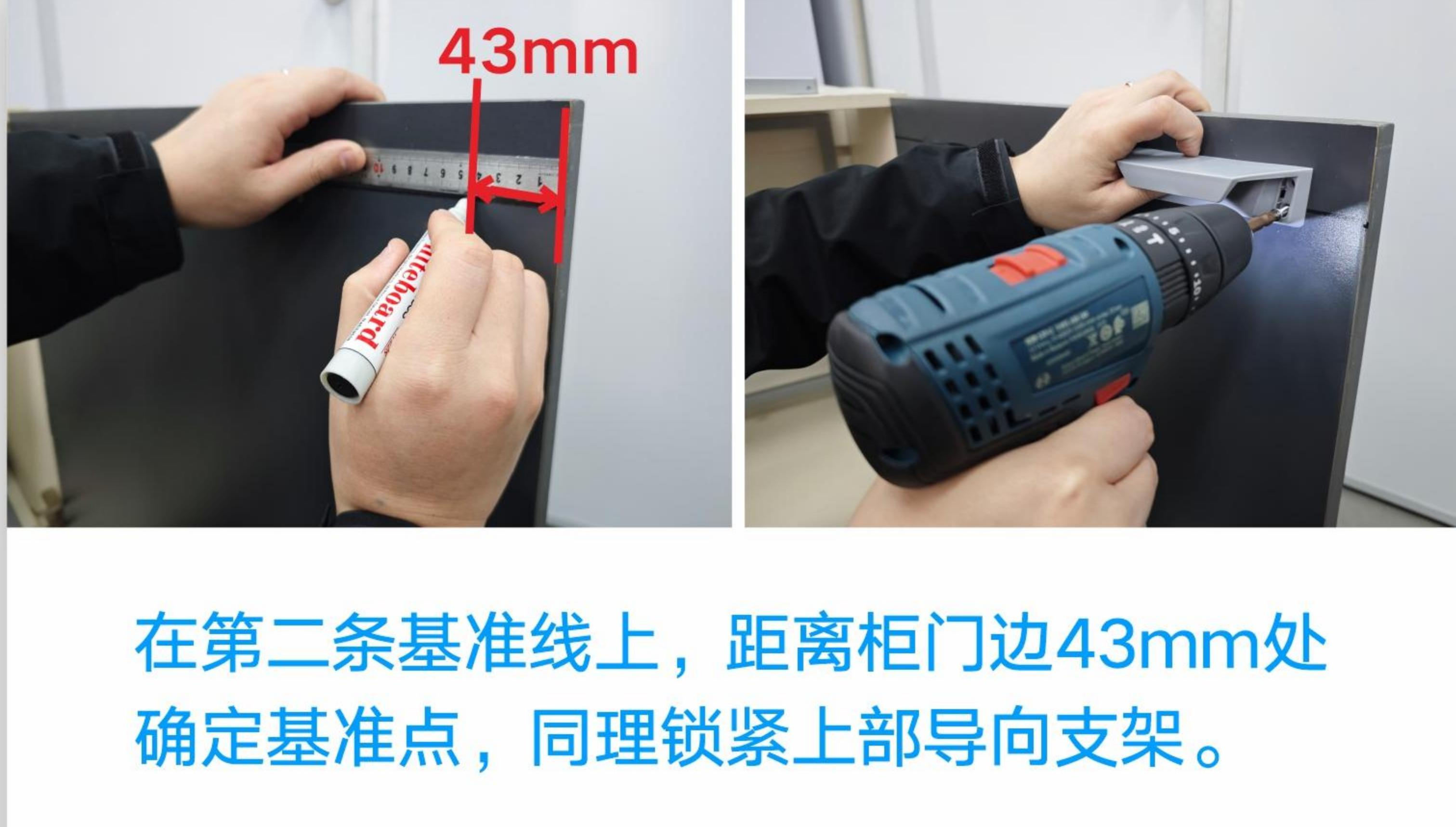
在第二条基准线上，距离柜门边43mm处确定基准点，同理锁紧上部导向支架。
