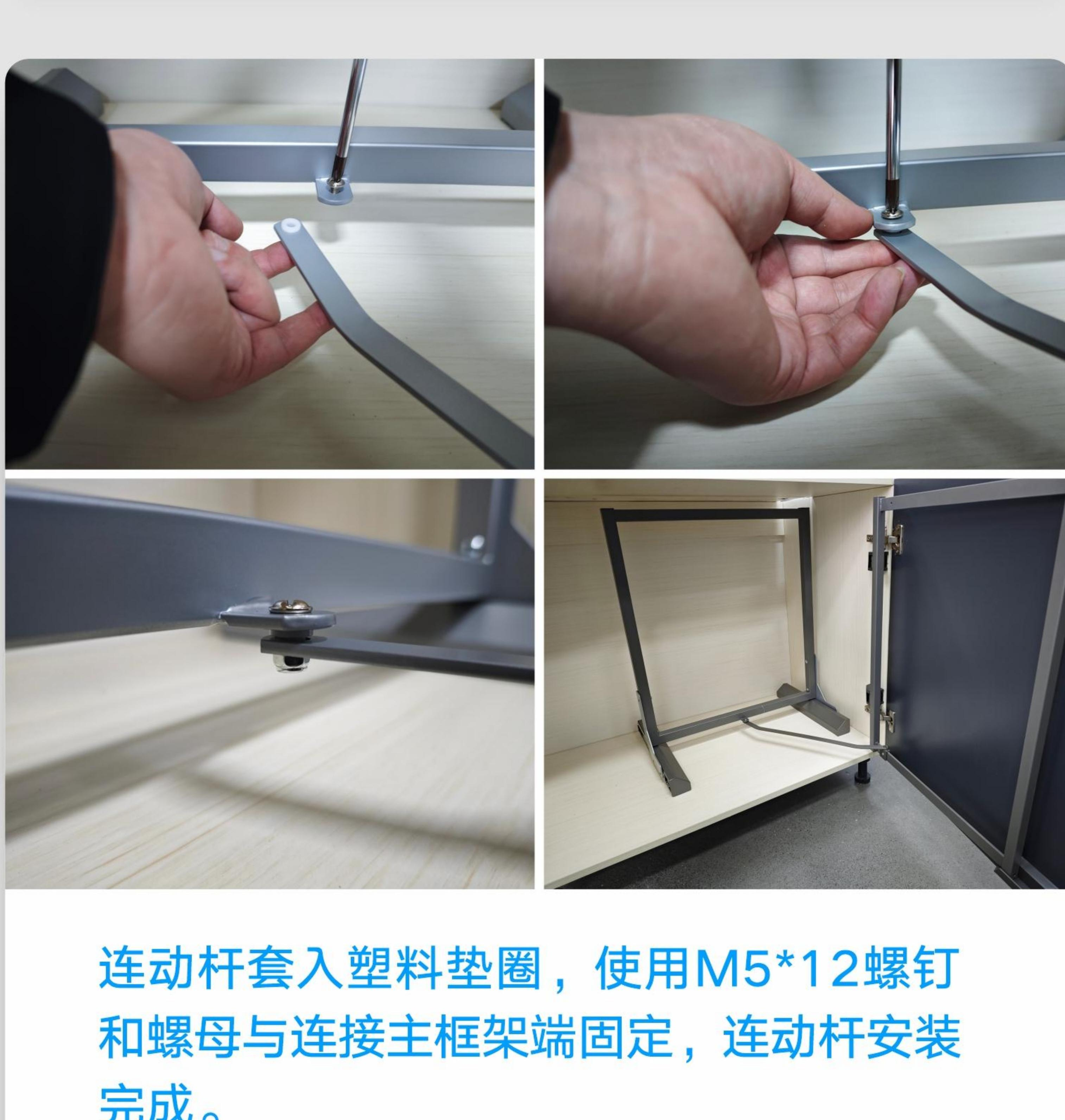
连动杆套入塑料垫圈，使用M5\*12螺钉和螺母与连接主框架端固定，连动杆安装完成。
